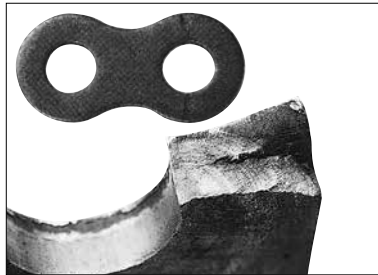
② 피로에 의한 파괴 피로 한도를 초과하는 반복적인 하중이 가해져서 구멍의 안쪽 면부터 균열이 발생하여 중간부터는 급격하게 파손됩니다.
