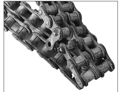
그림 34. 스테인리스 롤러 체인의 부식
