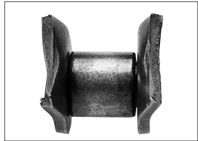
③ 읍셋 플레이트의 피로에 의한 파괴 읍셋 플레이트는 중앙에서 굽힘 가공되어 있으므로 구부러진 부분의 응력 집중에 의해 피로 파괴를 일으킬 수 있습니다. 읍셋 연결구는 가능한 한 사용을 피해주시시오.
